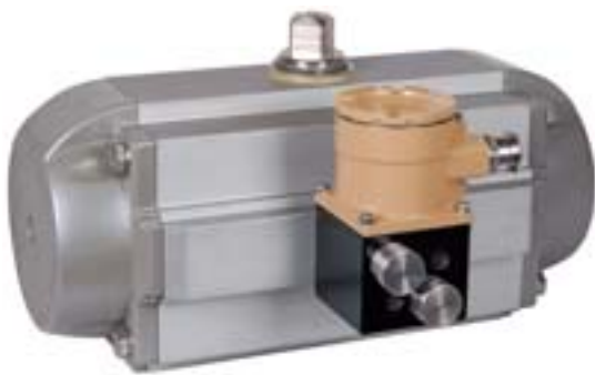
Direktanbau eines Magnetventils Typ 3966 an einen Schwenkantrieb mit Namur-Anbaufläche (VDI/VDE 3845)
